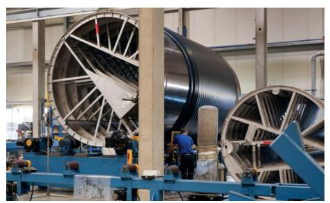
Fig. 2 - Production of wound pipes on a Krah machine at FRANK Kunststofftechnik GmbH
