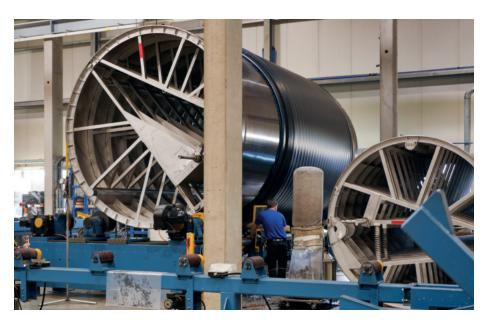
Fig. 2 - Production of coiled tubing at FRANK Kunststofftechnik GmbH
